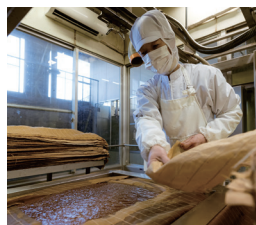
もろみを圧搾するための布を連続して詰める作業
