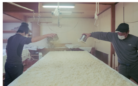
蒸米に麹菌を振りかける種切り作業。杜氏の経験と勘が麹の破精(はぜ)具合を決める
